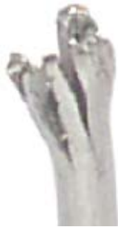
Рис. 9. Усталостное разрушение образца циклическим изгибно-крутильным нагружением. Трещины продольные
