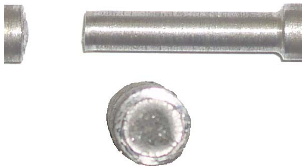
Рис. 7. Усталостное разрушение вала циклическим изгибным нагружением
