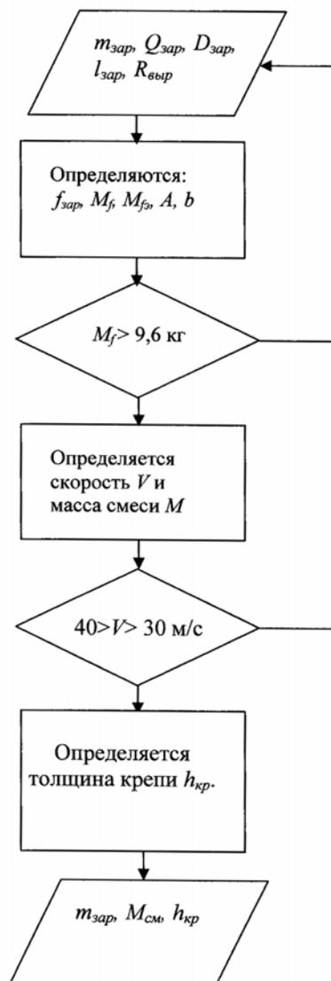
Рис. 1. Блок-схема к определению эффективных параметров взрывного способа возведения набрызгбетонной крепи
