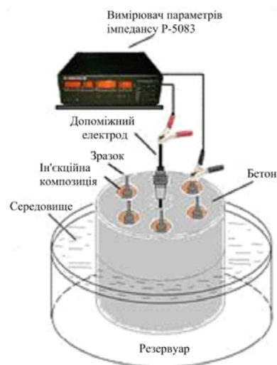
Рис. 2. Схема вимірювання імпедансу стержнів сталеві арматури, закріплених ін'єкційними композиціями з різними інгібіторами у бетонній чарунці
