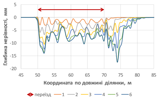
Рис. 6. Моделювання розвитку нерівності колії в зоні переїзду:
