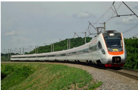
Рис. 3. Двосистемний електропоїзд ЕКр–1 «Тарпан»
