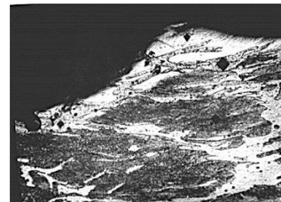
Рис. 4. Мікроструктура поверхневих шарів з відбитками алмазної піраміди, х 300
