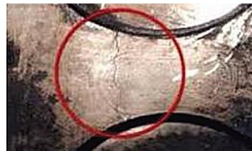
Рис. 2. Дефекти блока циліндрів:
