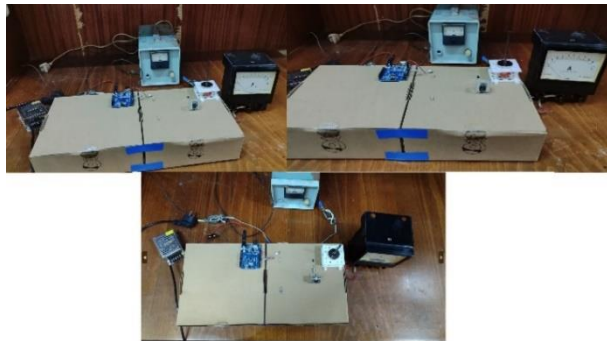
Рис. 2. Експериментальна установка для визначення динамічних показників котушок натурної моделі
