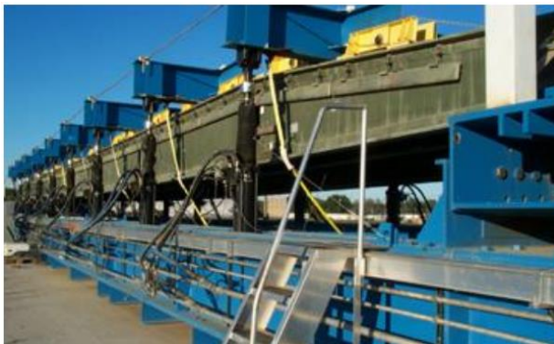
Рис. 2. Випробування на міцність елементів мосту
