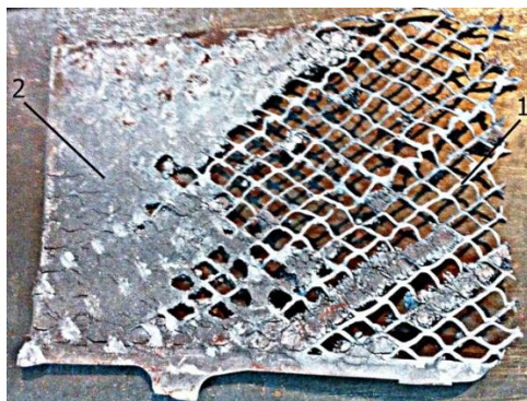
Рис. 3. Акумуляторна пластина: 1 – свинцеві ґрати; 2 – сульфатно-оксидна складова
