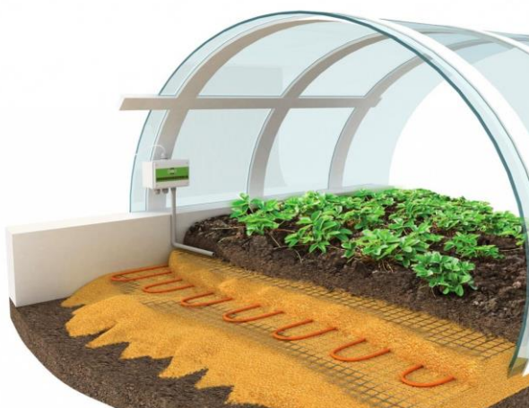
Рис. 1. Електрична система опалення теплиці https://eco-obogrev.com
