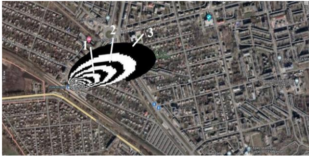
Рис. 6. Зона хімічного забруднення, t = 9 хв: 1 - C = 77 мг/м 3 ; 2 - C = 58 мг/м 3 ; 3 - C = 24 мг/м 3
