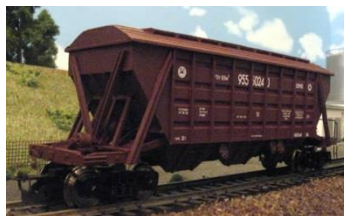
Рис. 1. Основні типи вантажних вагонів української залізниці: a – платформа; б – критий вагон; в – піввагон; г – цистерна; д – хопер; е – рефрижератор Fig. 1. The main types of freight cars of the Ukrainian railway: a – platform; b – covered wagon; c – semi-wagon; d – tank; e – hopper; f – refrigerator
