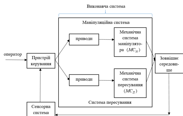
Рис. 1. Функціональна схема робота
