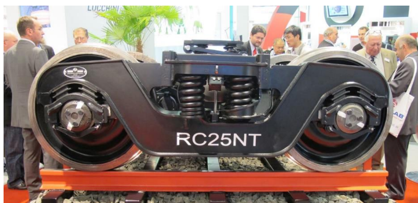
Рис. 4. Зварна конструкція візка залізничного вагона типу RC25NT
