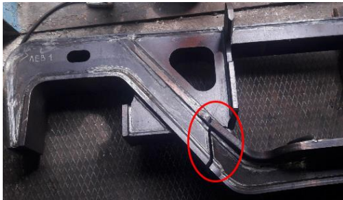
Рис. 12. Руйнування дослідного зразка № 1 суцільнозварної бокової рами після прискорених випробувань на втому:
