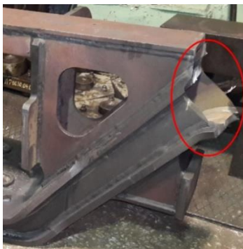
Рис. 13. Руйнування дослідного зразка № 2 суцільнозварної бокової рами після прискорених випробувань на втому:
