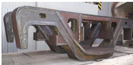
Рис. 11. Дослідні зразки суцільнозварної бокової рами:
