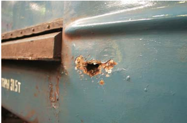
Рис. 1. Сквозная коррозия обшивки кузова и коррозия рамы вагона под ней
