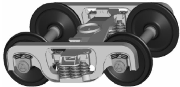
Рис. 1. Общий вид трёхэлементной тележки с упругим опиранием боковой рамы на буксу
