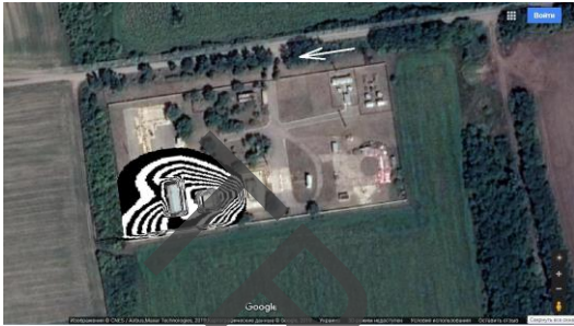
Рис. 3. Зона забруднення атмосферного повітря, розрахунок виконано з урахуванням будівель на території насосної станції (рівень z = 2,5\text{ м} , t = 35\text{ с} )
