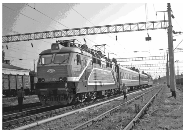
Рис. 1. Загальний вигляд електровоза ВЛ40 у (виробництва ЗЕРЗ) та дослідний зчеп під час проведення випробувань
