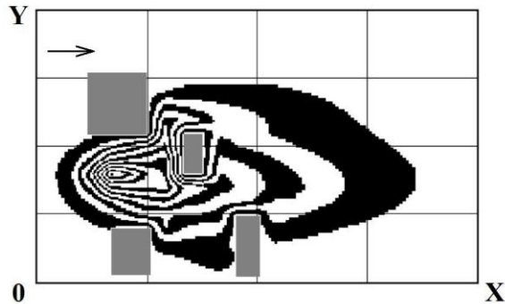
Рис. 2. Изолинии концентрации аммиака при гипотетическом теракте \tau = 14 (время безразмерное, решение «прямой» задачи): I – место эмиссии агента
