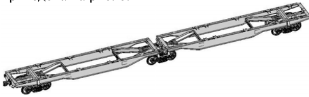
Рис. 6. Сочлененная вагон- платформа модели 13-1839
