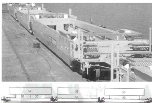
Рис. 5. Вагон-платформа типа Maxi-Strack IV
