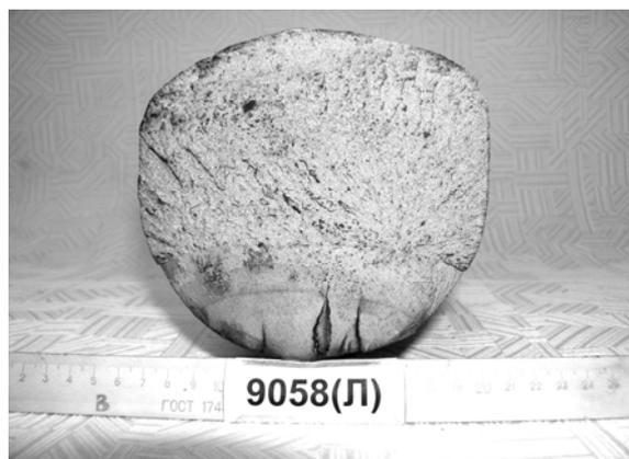
Рис. 6. Вид излома разрушенного образца шейки оси
