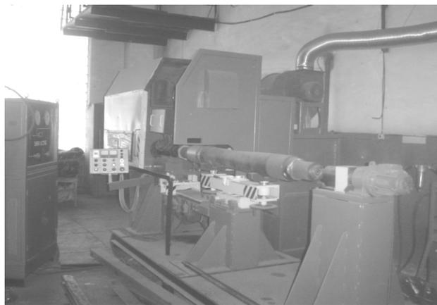
Рис. 3. Общий вид установки для восстановления шейки и подступичной части оси колесной пары методом плазменно-дуговой металлизации КТ-088
