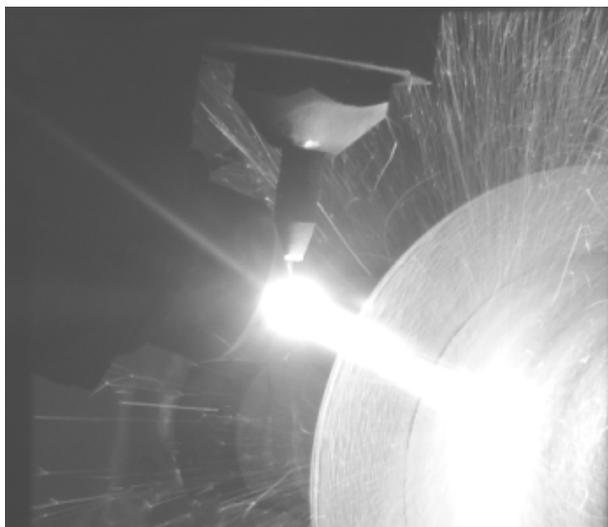
Рис. 4. Процесс плазменно-дуговой металлизации шейки оси
