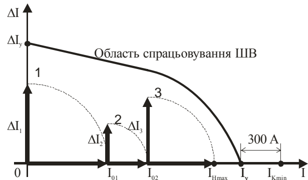
Рис. 4. Оптимальна характеристика спрацювання при тяговому навантаженні
