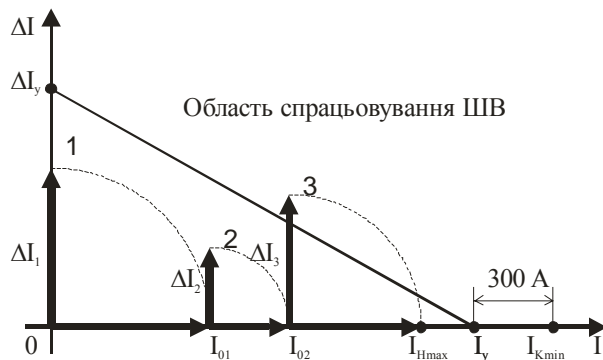
Рис. 3. Характеристики спрацювання при тяговому навантаженні
