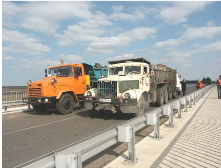
Рис. 2. Випробування шляхопроводу на км 261+441
